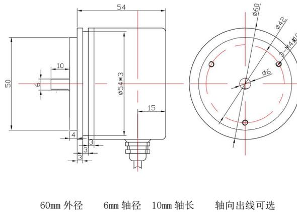
盲孔型/半通孔法兰 ( 电缆输出或插头输出可选 )
