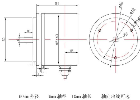
通孔法兰 ( 电缆输出或插头输出可选 )
